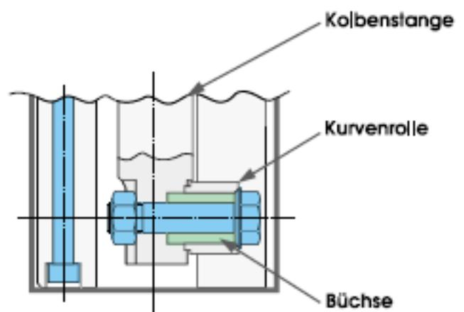
Größere modulare Standardisierung wurde für die individuellen Rollen-Befestigungsteile entwickelt; somit können sie für alle Vorformboden-Trichter und Ausblas-Mechanismen der 200 Serie (EF 4-1/4" und EF 5") und 210 Serie (EF 5-1/2" und AIS TG 4-1/4" und 6-1/4") verwendet werden.
